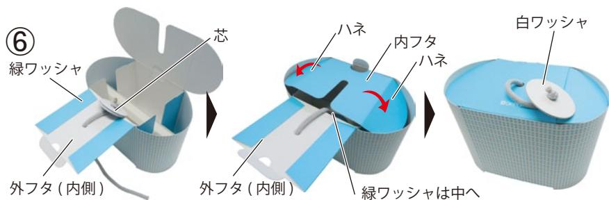
外フタを開けて芯を中に奥まで押し込んで下さい。緑ワッシャは外フタの内側になるようにヒモを通します。内フタのハネを本体に差込み、外フタを閉じます。最後に白ワッシャにヒモを通して結べば完成です。ヒモの結び方は右図をご参考下さい。
